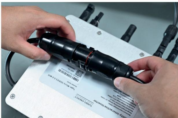
7. Enchufa a la red. Espera unos minutos hasta que los paneles tengan suficiente luz solar para que el microinversor se encienda.
