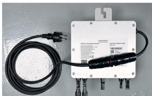
5. Conecta los paneles solares al microinversor utilizando los dos cables MC4 incluidos en el kit. Cada panel conéctalo a un cable MC4 y los cables conéctalos a las dos entradas del mismo PV del microinversor
