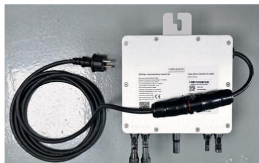
5. Conecta los paneles solares al microinversor utilizando los cuatro cables MC4 incluidos en el kit. Cada panel conéctalo a un cable MC4 y los cables conéctalos a las cuatro entradas teniendo en cuenta que los paneles pareados deben ir al mismo PV del microinversor
